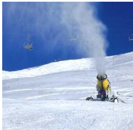
Tehnika razprševanja z nizkim tlakom zraka
